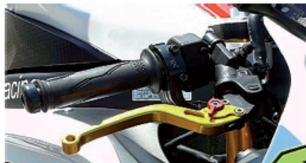
7) TITAX-Hebel am Motorrad. Überprüfen Sie Funktion und Position der Bremshebel-Einstellung. Überprüfen Sie die Funktion der Bremsleistung
