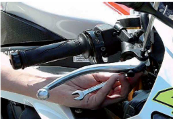
2) Verwenden Sie Schraubenschlüssel und Schraubendreher um Mutter und Schraube, welche den Hebel halten, zu lösen. Verwenden Sie den Schraubenschlüssel passend zur Größe der Mutter.
