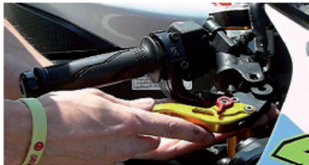
6) Geben Sie während der Montage acht auf den Bremslichtschalter (wenn es einen hat). Verwenden Sie Schraubenschlüssel und Schraubendreher um Mutter und Schraube, die den Hebel halten, wieder zu montieren. Verwenden Sie 6-10 Nm Drehmoment, wenn die Schrauben angezogen sind und berücksichtigen Sie die Angaben im Motorradhandbuch des Herstellers zur Bestätigung. Überprüfen Sie die Funktion des Bremslichtschalters und finden Sie die richtige Position für die Einstellung des Bremshebels. Der Hebel muss beim ersten Drittel Ihrer Finger einrasten, dann ist er perfekt montiert und eingestellt.
