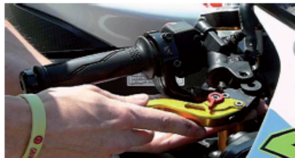
5) Schmieren Sie den Hebel, bevor Sie ihn montieren. Verwenden Sie nur geprüfte Schmiermittel für die Lager. Legen Sie den TITAX-Hebel anstelle des Originalhebels zurück.
