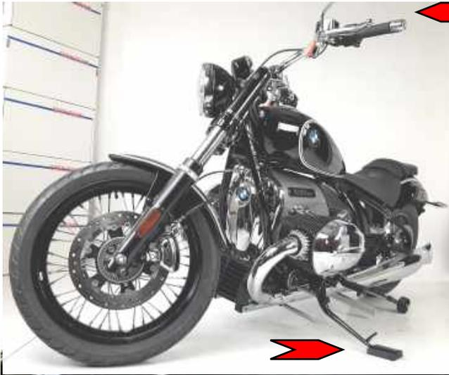
Startposition grundsätzlich zum Ein & Aushängen Gummi-Block unter Seitenständer legen und den Lenker nach rechts einschlagen! Dadurch leichteres Ein und Aushängen des Adapters!
