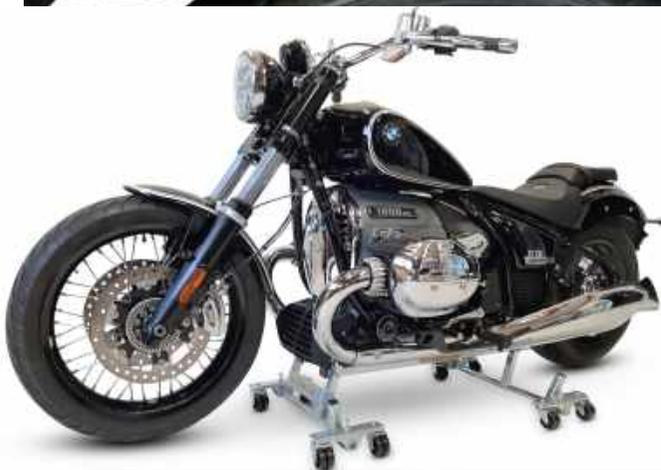
Front-Partie wird erst eingesetzt wenn Maschine hinten aufgebockt ist! Immer zuerst vorne Abbocken!
